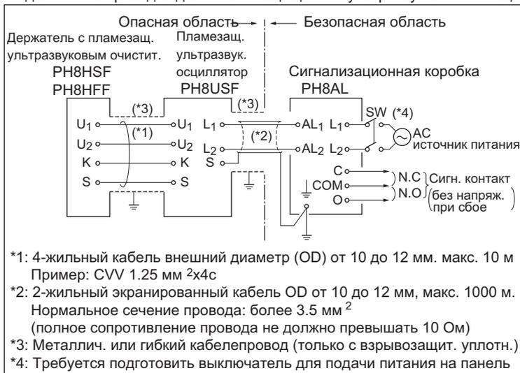
Подключение проводов для ультразвуковой системы очистки невзрывозащищенного исполнения
