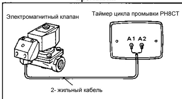
**Рисунок 2-24 Соединения для схемы привода электромагнитного клапана**
