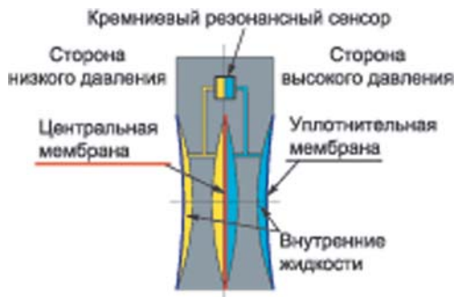
Рис. 4. Устройство защиты от перегрузки по давлению датчика EJA110
