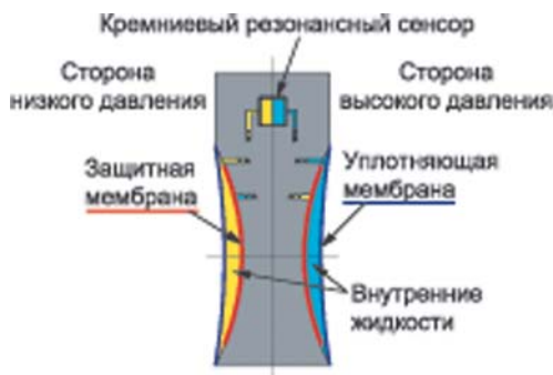
Рис. 5. Новый механизм защиты от перегрузки по давлению датчика EJX 110
