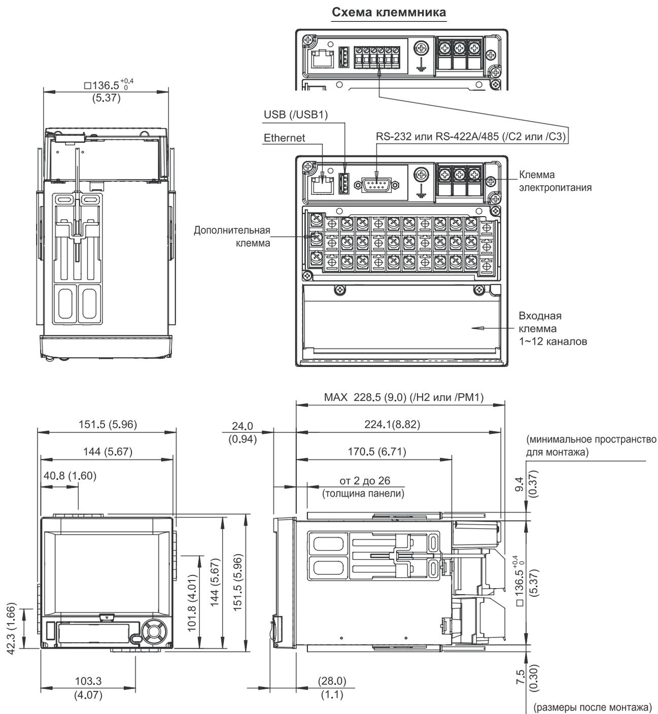
Примечание: Если не указано, тот допуск равен  $\pm 3\%$ . Однако, для размеров менее 10 мм допуск равен  $\pm 0.3$  мм.
