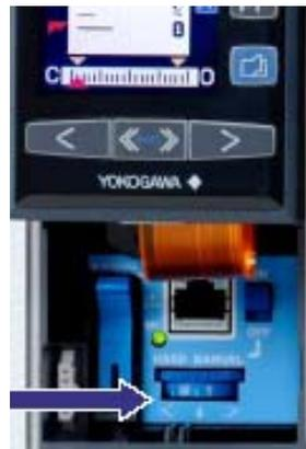
Рабочее колесо жесткого ручного управления
